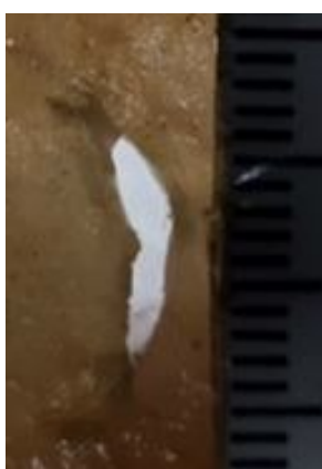
Рис. 12–14. Повреждения, образованные ножами на трикотаже, ткани и натуральной коже
