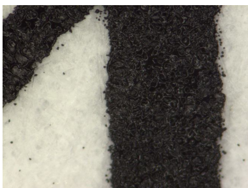
Рис. 16. Увеличенное изображение штрихов тонера после воздействия СВЧ-излучения в течение 1 минуты
