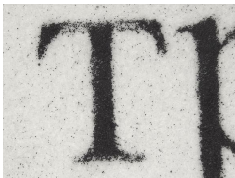
Рис. 14. Увеличенное изображение штрихов текста, нанесенного на документ электрофотографическим способом печати и состаренного путем неоднократного прогона листа бумаги через узел термического закрепления тонера (фьюзер)
