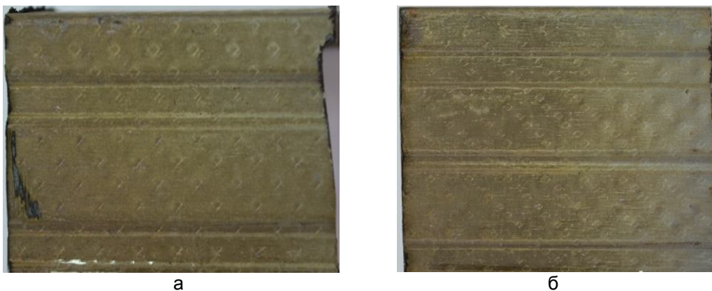
Рис. 4. Образцы профиля, полученного при температуре 900 °С: а – стоечного; б – направляющего
